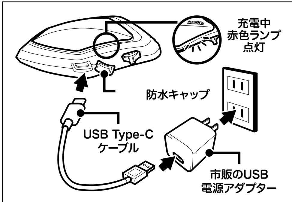
1 インカム本体にUSBケーブルを差し込み電源アダプターを接続する。
